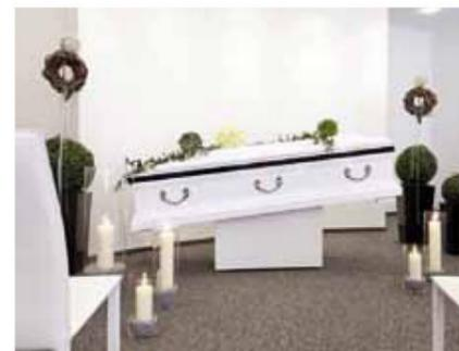
Die architektonischen Tricks zur Lösung der genannten Probleme sind schnell erzählt. Ein verglaster Windfang und schallschluckende Vorhangstoffe reduzierten den Verkehrslärm, ein Wandbogen im Bereich der Aufbahrung und der offenporige Bodenbelag sorgten für die richtige Akustik und ein fähiger Statiker rechnete die tragende Stütze klein. Steuerbare Leuchten ermöglichten unterschiedliche Raumwirkungen für die jeweiligen Veranstaltungen.
